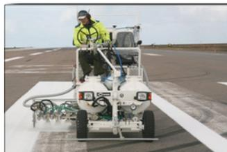
**H18** en Islandia con sistema de depósitos presurizados para pinturas en frío, 2 x 225 l depósitos presurizados y con marcador aeroportuario de 90 cm con 3 pistolas de pinturas y de esferas cada uno
