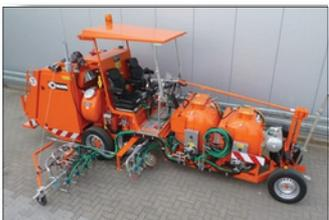
**H33** en Cairo/Egipto con sistema de depósitos presurizados para pinturas en frío, 1 x 460 l y 2 x 220 l depósito presurizado, con marcador aeroportuario de 90 cm con cada uno 4 pistolas de pinturas y de esferas así como cada uno 2 pistolas de pintura y de esferas para taxiways
