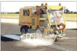
**H35** en Dublín / Irlanda con bombas para pinturas en frío de 1-componente así como con sistema de depósitos presurizados para pinturas en frío y con marcador aeroportuario de 90 cm con 4 pistolas de pinturas así como 1 pistola de pintura para taxiways, 1 x 320 l y 1 x 225 l depósitos presurizados
