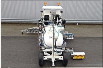
**H33** en Abu Dhabi/E.A.U. con sistema de pinturas en frío de 1-componente Airless con 3 bombas Airless, 1 x 460 l y 2 x 220 l (dividido) depósitos presurizados, con marcador aeroportuario de 90 cm, con 4 pistolas de pintura y de esferas y con 3 pistolas de pintura y de esferas adicionales para taxiways (negro/amarillo/negro)
