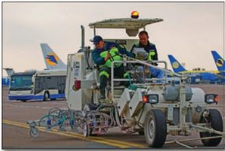
**H33** en Kiev/Ucrania con sistema de depósitos presurizados para pinturas en frío, 2 x 385 l depósitos presurizados, con marcador aeroportuario de 90 cm con 4 pistolas de pinturas y de esferas cada uno así como 2 pistolas de pintura y de esferas cada uno para taxiways
