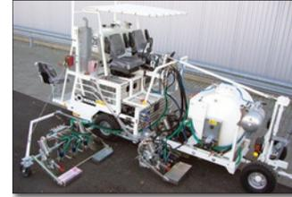
**H18** en Belgrado / Serbia con sistema de depósitos presurizados para pinturas en frío, 1 x 460 l depósito presurizado y con marcador aeroportuario de 90 cm con 3 pistolas de pinturas y discos de rodillo así como 1 pistola de pintura con discos de rodillo para taxiways
