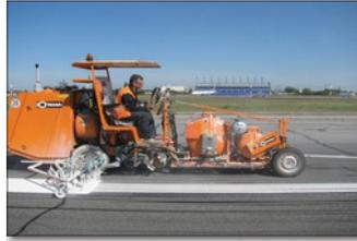
**H26** en Bucarest/Rumanía con sistema de depósitos presurizados para pinturas en frío, 1 x 460 l y 1 x 225 l depósitos presurizados, con marcador aeroportuario de 90 cm con 3 pistolas de pinturas y de esferas cada uno así como 2 pistolas de pintura y de esferas cada uno para taxiways
