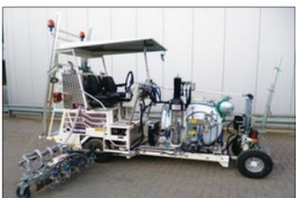
**H18** en Singapur equipada para sistema de pintura en frío de 1-componente Airless, con marcador aeroportuario de 120 cm y con 5 pistolas de pintura y esferas, depósito presurizado 460 l
