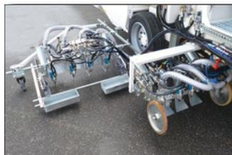
... construido como sistema modular con cierre rápidos eléctricos e hidráulicos así como barras de conexión para un intercambio rápido de las unidades de aplicación mediante carretilla de horquilla elevadora
