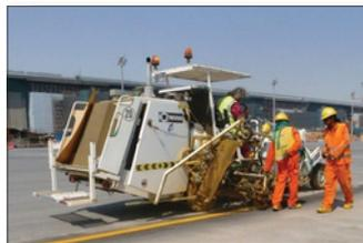
**H33** en Doha / Catar con sistema de 2 colores de depósitos presurizados para pinturas en frío, 1 x 540 l y 1 x 385 l depósito presurizado, con marcador aeroportuario de 90 cm con 4 pistolas de pinturas y dispersor de esferas (difusor) sobre 4 pistolas de esferas así como cada uno 2 pistolas de pintura y de esferas para taxiways
