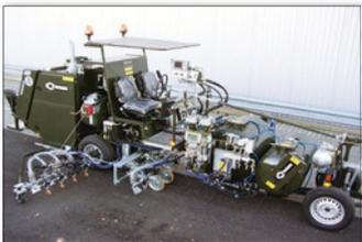
**H26** en Portugal (base aeroportuario) con sistema de pinturas en frío de 1-componente Airless, 1 x 540 l y 1 x 385 l depósitos presurizados y con marcador aeroportuario de 90 cm con 4 pistolas de pinturas y de esferas cada uno así como 1 pistola de pintura y de esferas cada uno para taxiways
