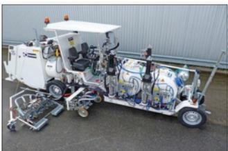
**H33** en Muscat/Omán con sistema Airless para para pinturas en frío de 1-componente, 1 x 460 l y 1 x 220 l depósitos presurizados, con marcador aeroportuario de 90 cm con cada uno 4 pistolas de pinturas y de esferas con discos de rodillo así como cada uno 3 pistolas de pintura y de esferas para líneas negras/amarillas/negras (taxiways) y ...
