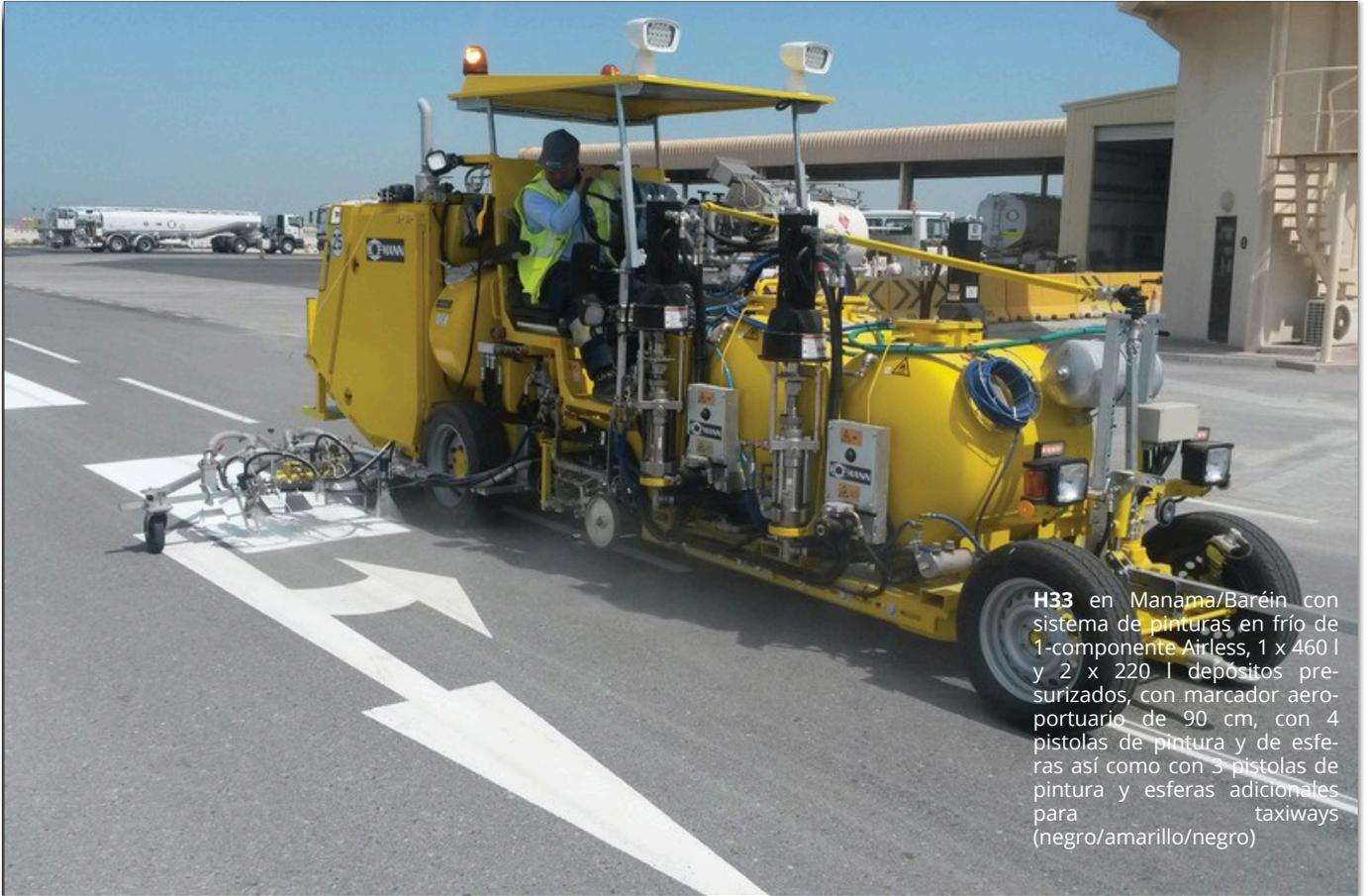
**H33** en Manama/Baréin con sistema de pinturas en frío de 1-componente Airless, 1 x 460 l y 2 x 220 l depósitos presurizados, con marcador aeroportuario de 90 cm, con 4 pistolas de pintura y de esferas así como con 3 pistolas de pintura y esferas adicionales para taxiways (negro/amarillo/negro)
